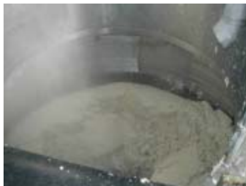
図 2-59 離解後の低濃度パルパー内部
