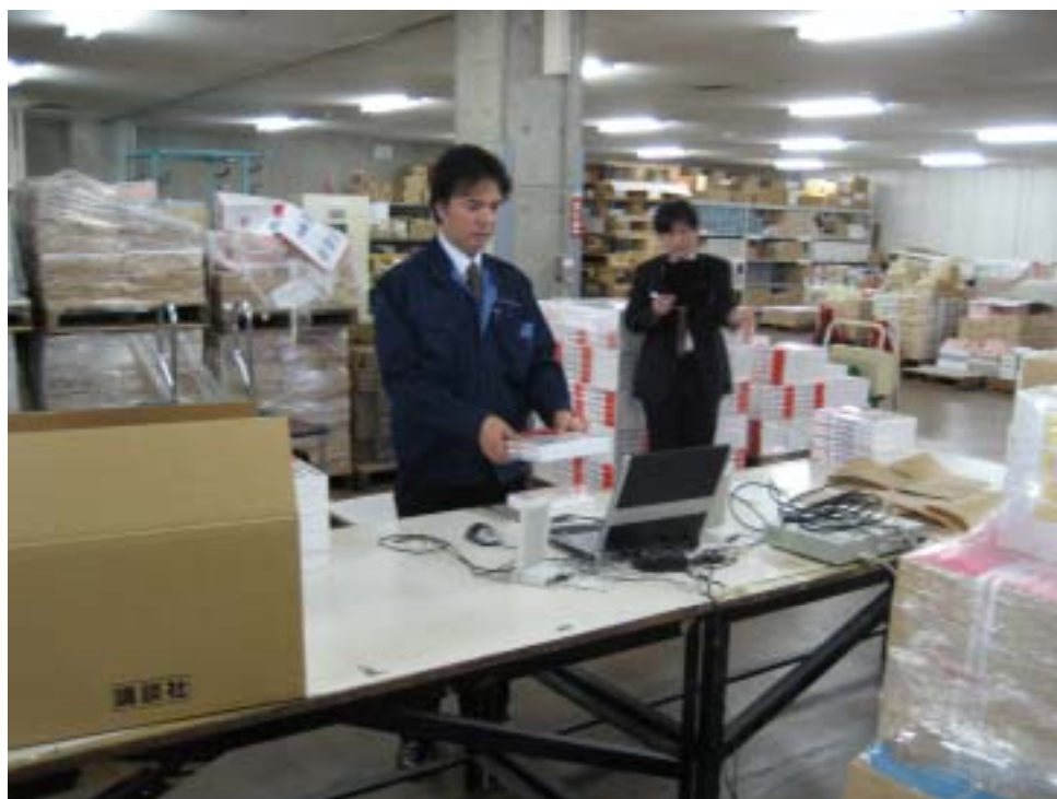
図 3-21 電子タグを用いた作業（出荷現場での検品）
